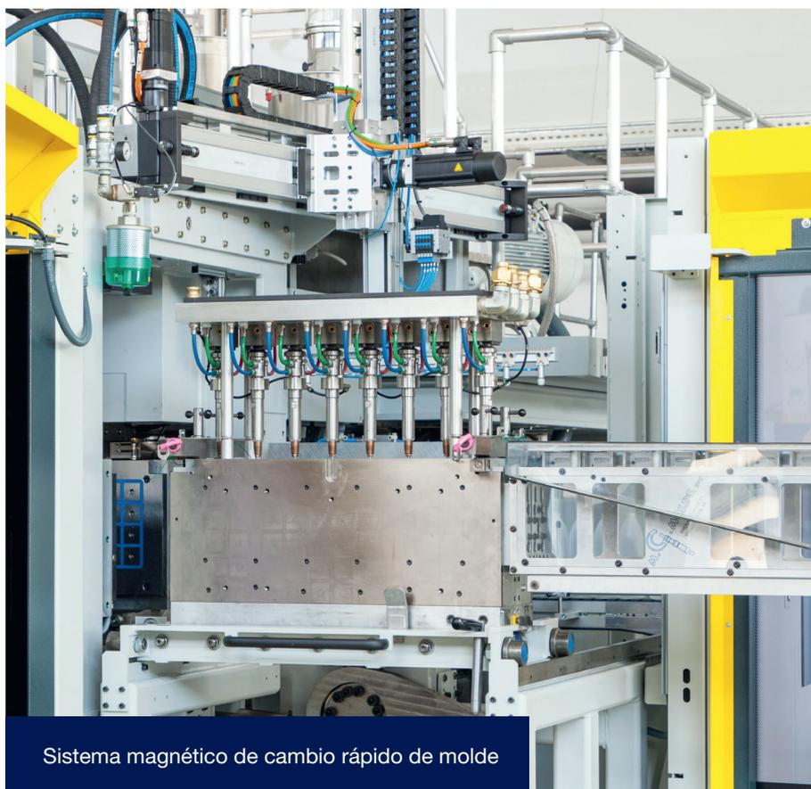
Sistema magnético de cambio rápido de molde
