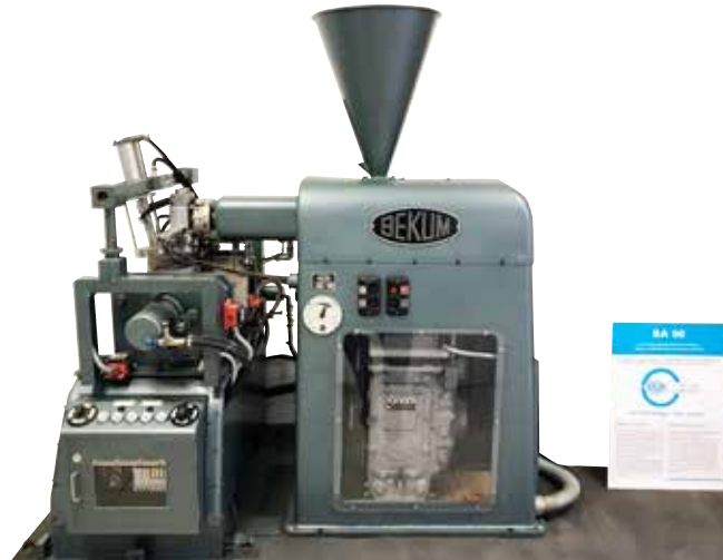
BA 90 – die weltweit erste Blasformmaschine mit ausgebildeter Ringflächen-Kalibrierung
